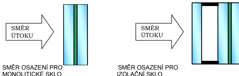
Obrázek 9 Sklo odolné proti násilnému vniknutí použité v izolačním zasklení
